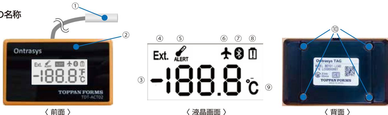
①外部センサ(BDT01-LC40:半導体センサ、BDT01LC196:白金センサ) ②LED ③温度表示部 ④外部センサ表示部 ⑤温度アラート表示部
