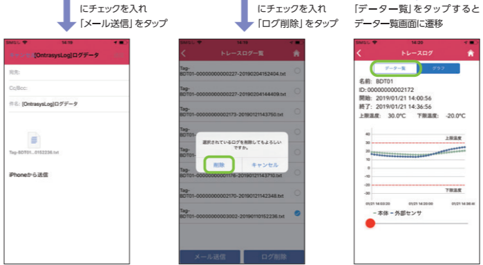
メールを送信したいログにチェックを入れ「メール送信」をタップ 削除したいログにチェックを入れ「ログ削除」をタップ 「データ一覧」をタップするとデータ一覧画面に遷移 画面に指を2本のせ、広げたり閉じたりすることでグラフの拡大、縮小が可能
